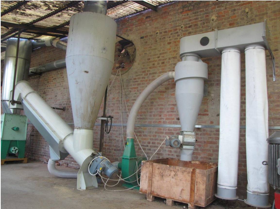
3. ábra. Csigás kiadagoló, rostás tisztító; porleválasztó
