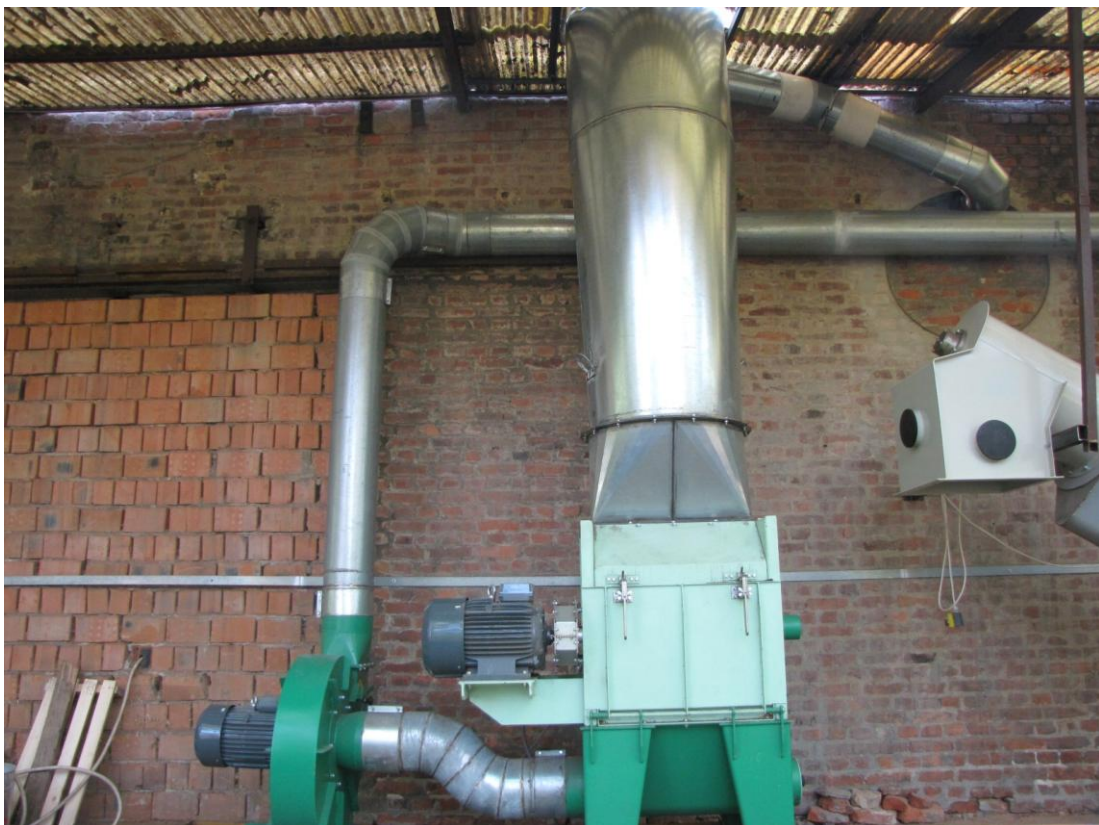
2. ábra. Pneumatikus szállítógép, finom daráló
