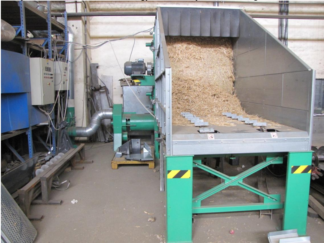
1. ábra. Vízszintes tengelyű hengeres durva aprító + csigás kihordó + szétválasztó + vezérlő
